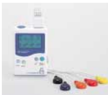
FM-120 電池とカードを含んでもわずか約110gの超小型ホルター心電計。心電図2chを記録できる。
