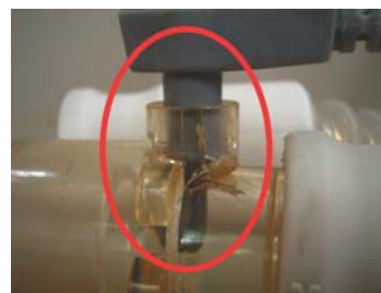
温度プローブ接続部の破損
